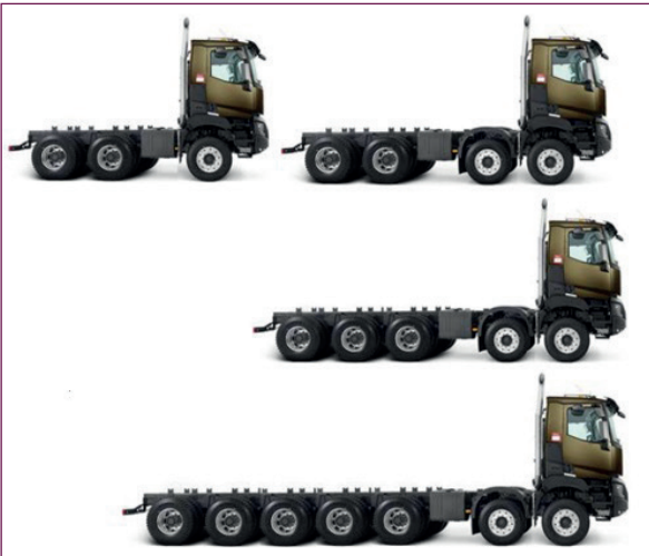
Görsel-3: Daha fazla yük taşınmasına imkan sağlamak amacıyla artırılan teker sayısı.
